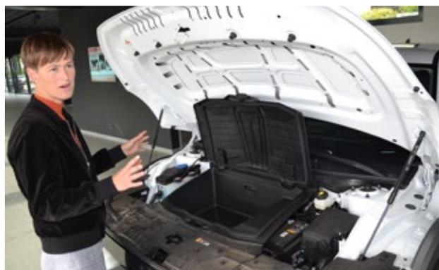
Larissa Brückner zeigt uns hier eine Besonderheit eines Elektrofahrzeuges: der sogenannte Frunk. Ein Elektromotor benötigt weniger Platz, so spart man Raum in der Fahrzeugfront, um z. B. das Ladekabel zu verstauen.
